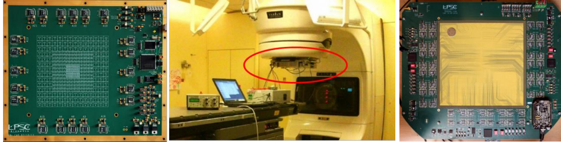
Figure 7-3 : Photos du prototype exploité actuellement (gauche), du support dédié pour les accélérateurs Varian (milieu) et du prototype sur le point d'être testé sous faisceau (droite).
