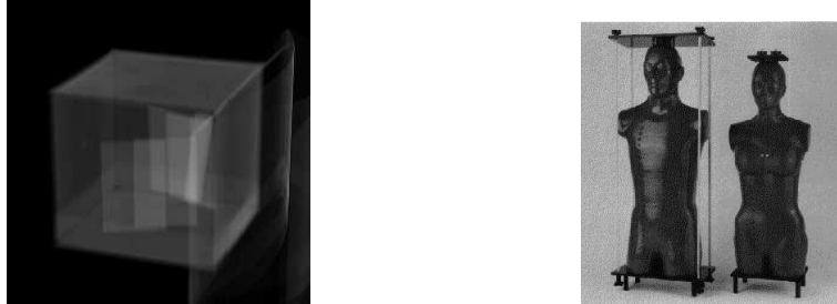
FIG. 2.6 – À gauche : un rendu volumique du cube utilisé pour l'étalonnage (nous pouvons ainsi apercevoir les structures internes du cube). À droite : le fantôme d'Alderson.
