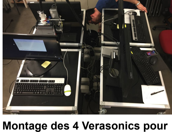
Montage des 4 Verasonics pour sonication synchronisation
